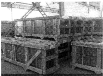
图 1-3 玻璃的运输包装
