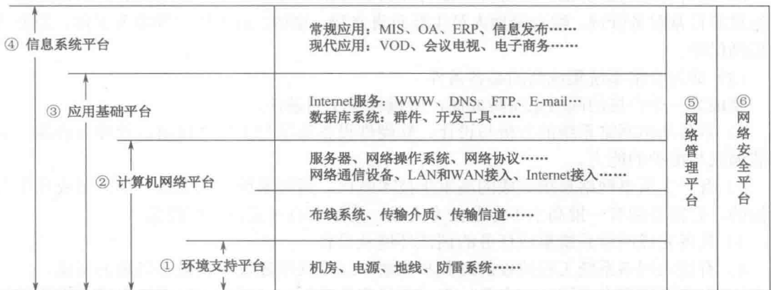
图 1-5 网络系统集成体系架构
