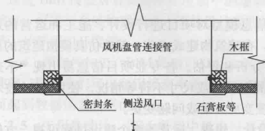
图 1-2-5 风口与风管连接示意
