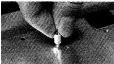
图 1-10 安装主板垫脚螺母
