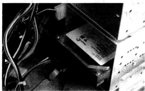
图 1-16 安装硬盘线缆
