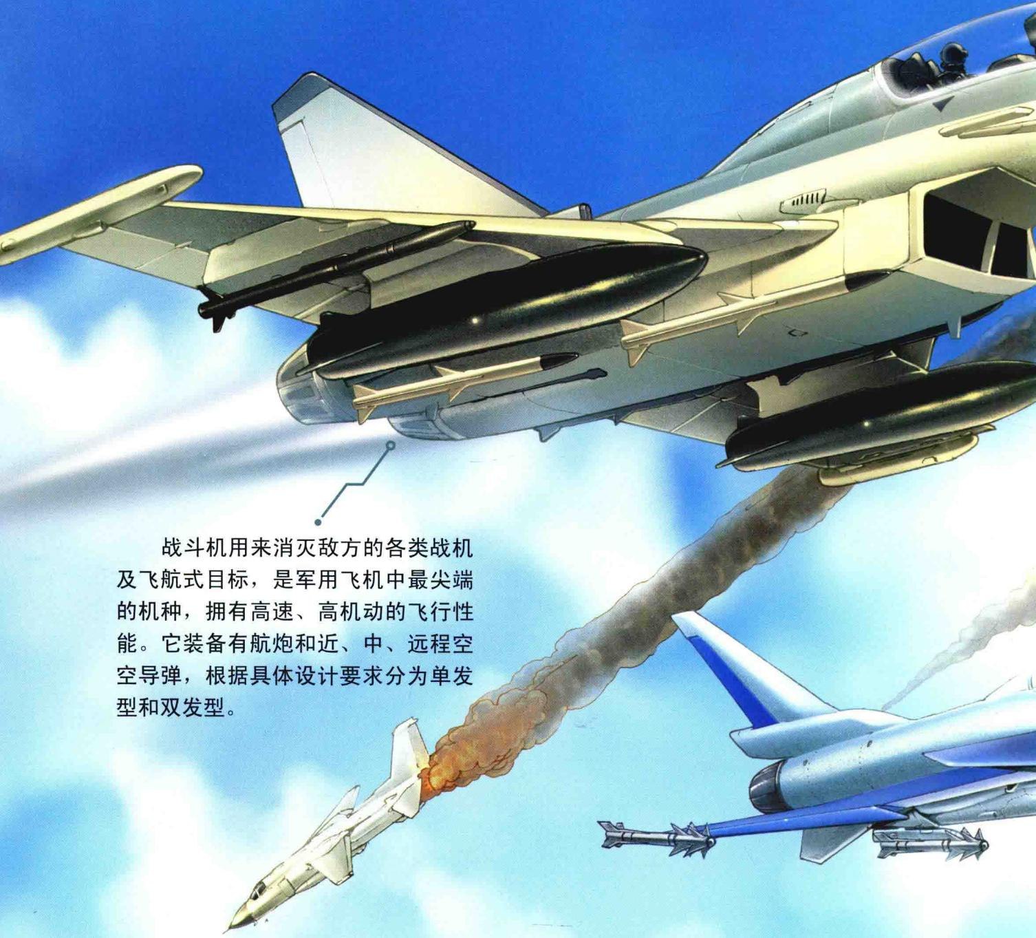
战斗机用来消灭敌方的各类战机及飞航式目标，是军用飞机中最尖端的机种，拥有高速、高机动的飞行性能。它装备有航炮和近、中、远程空空导弹，根据具体设计要求分为单发型和双发型。
