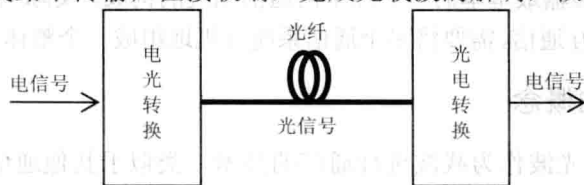
图 1.4 光纤通信系统简化示意图
