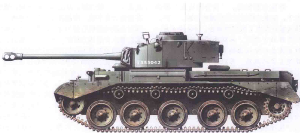
▲ 装有“77 mm HV”短管 QF 17 磅炮的“彗星”巡洋坦克侧视图
