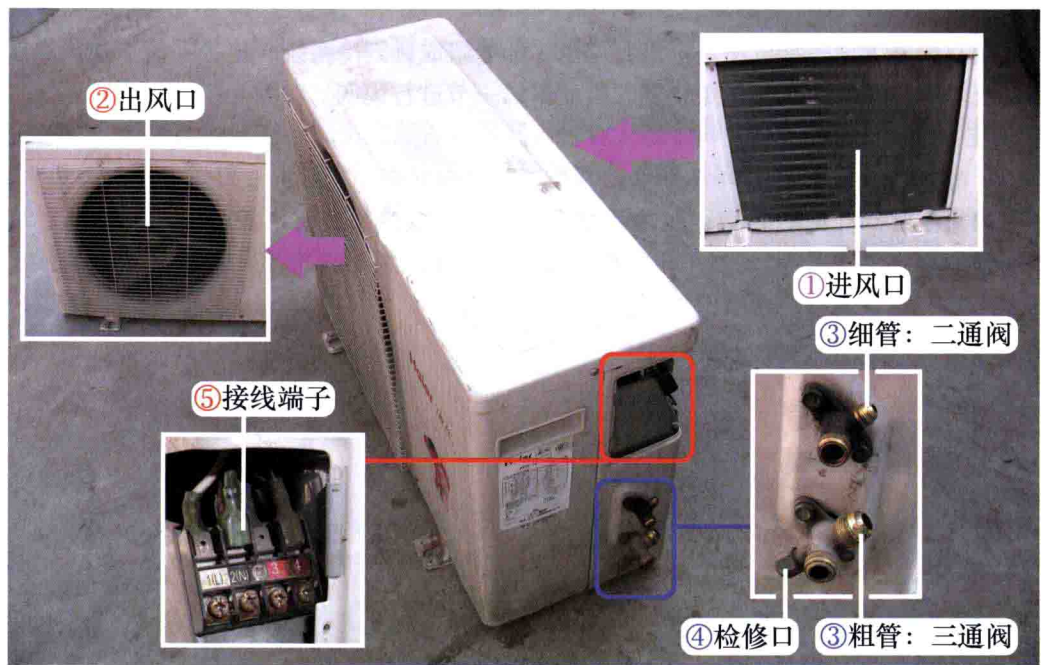
图 1-12 室外机外部结构
