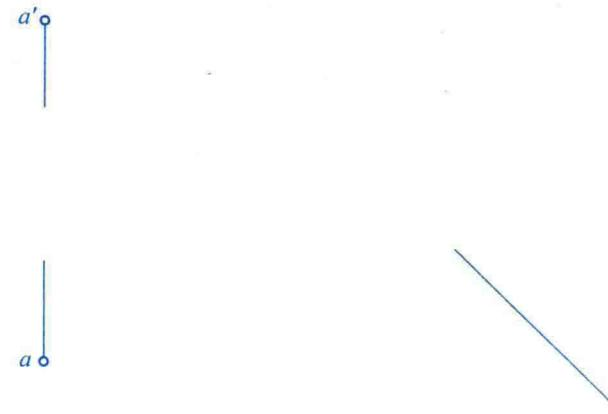
2. 已知直线 AB 的 H 面投影及 V 面投影上的一点  $a'$ , 又知该直线对 H 面的倾角为  $30^\circ$ , 点 B 高于点 A, 试完成 AB 的两面投影。
