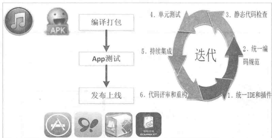
图 1-3 移动应用编译打包、测试及发布上线流程简图
