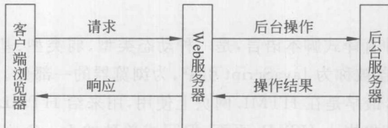
图 1-2 Web 应用程序工作原理
