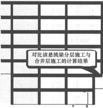
图 1.1.18 悬挑梁托柱工程实例
