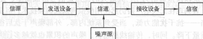
图 1-1 通信系统模型示意图
