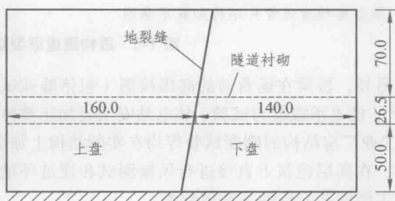
(b) 地裂缝试验模型（单位：cm）
