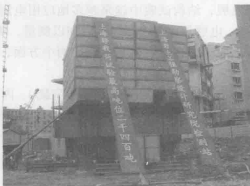
图 1-13 桩基静载试验
