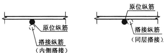
图 1-11 箍筋平直段处钢筋搭接位置
