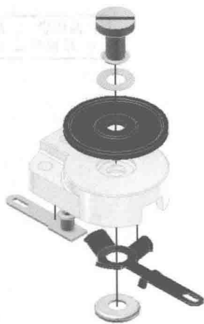
图 1-3 微调瓷介质电容器的三维装配爆炸图
