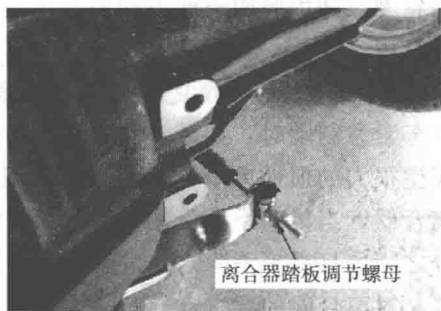
图 1-10 调节离合器踏板高度螺母
