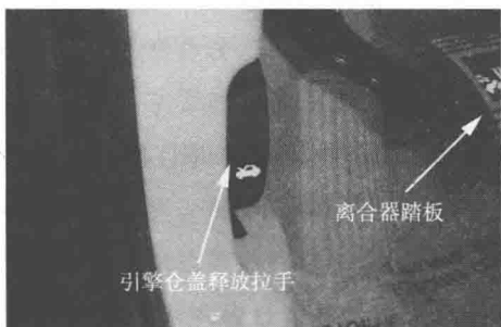
图 1-2 拉动引擎仓盖释放拉手
