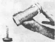
A. 击打纸筒一端让其发声看到火焰晃动,说明声音具有能量
