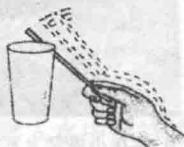
C. 用大小不同的力敲击杯子,声音的响度不同
