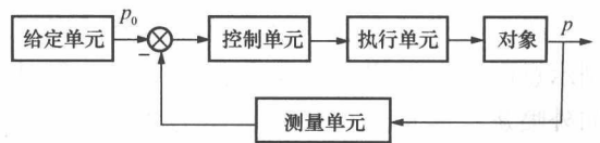
图 1-3 炉膛压力自动控制系统方框图
