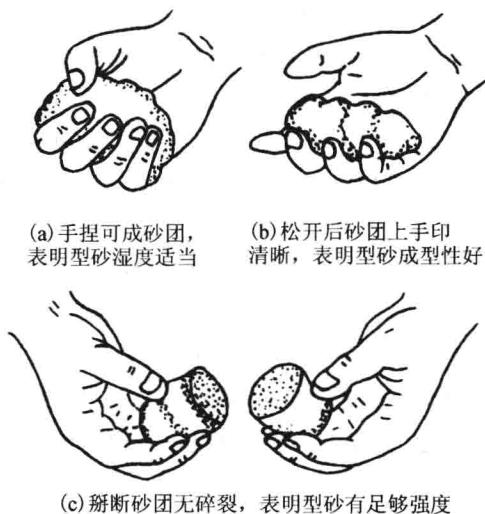
图 1-4 手感法检测型砂性能
