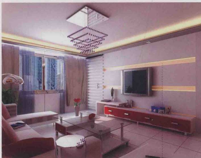
石膏板造型 + 黄色暗藏灯槽
