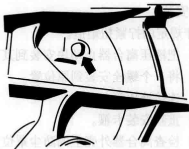
图 1-13 拧紧分离叉轴的定位螺栓
