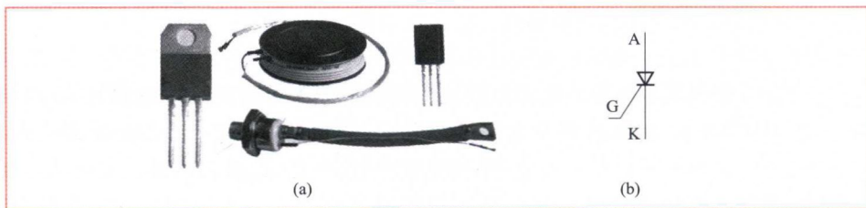
图 1-4 单向晶闸管 (a) 实物外形；(b) 图形符号
