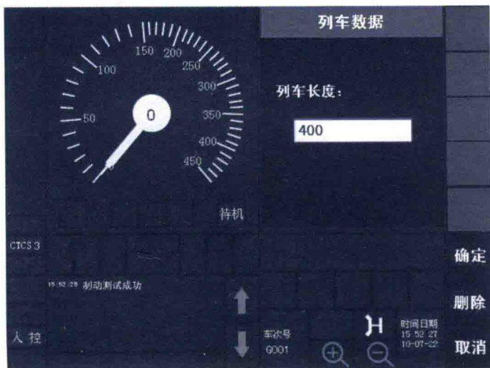
图 1.1-7 输入列车长度
