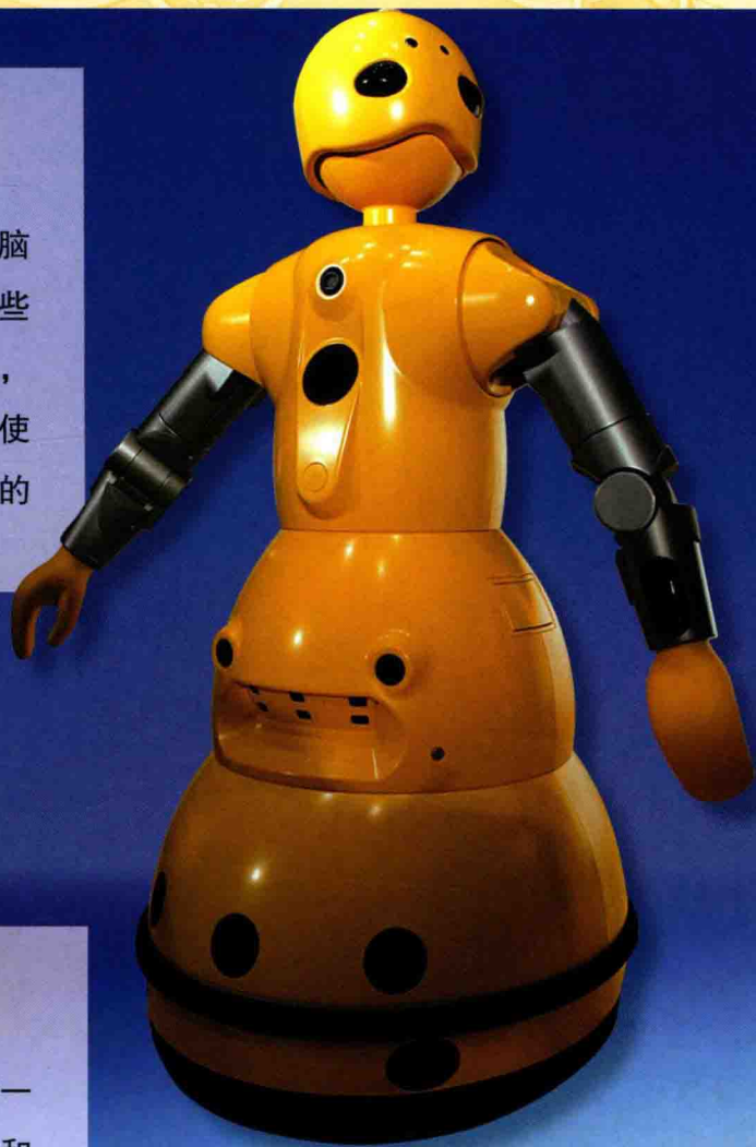
上图：三菱公司制造的机器人“牛若丸”是一种机器人伴侣。它能进行简单对话，并且会把屋里的异常情况报告给控制中心。这种机器人于2005年开始发售。
