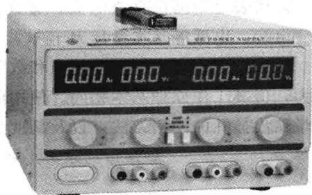
图 1.8 双路直流稳压电源外形
