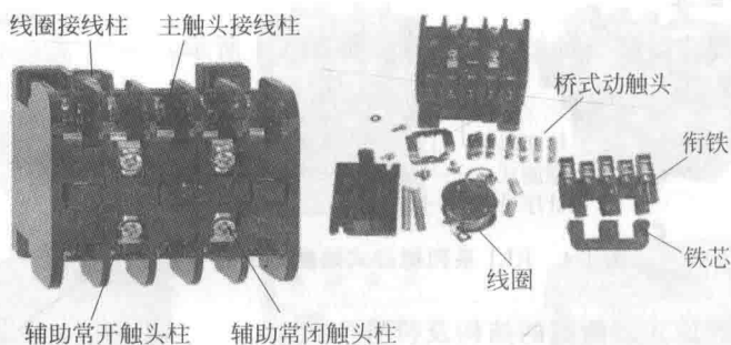
图 1-7 交流接触器结构
