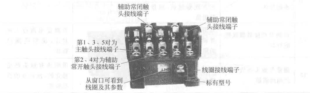
图 1-16 CJT1—10 型交流接触器外观结构
