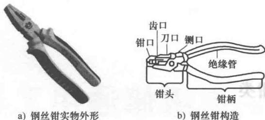
图 1-2 钢丝钳外形及构造
