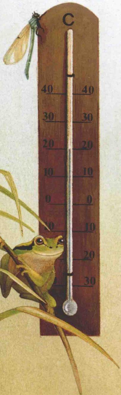
这支温度计指示着零上 20℃ (+20℃)。细管中有蓝色的液体。周围越热，液体就膨胀得越多，在管子中也就升得越高。
