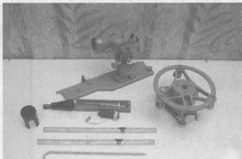
用于地面测量的仪器之一——平板仪
