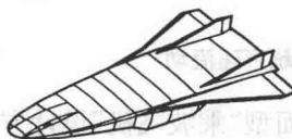
图 1.2.9 高超声速飞机的气动布局特征
