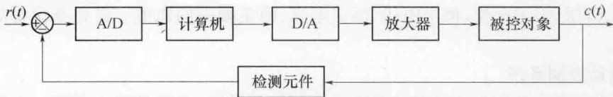
图 1-6 数字计算机控制系统
