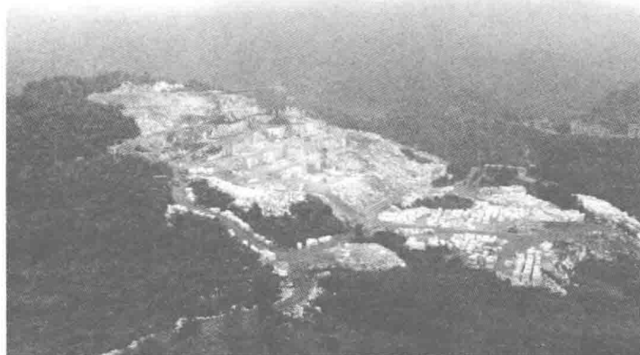
图 1-5 首采位置位于山顶的山坡露天开采大理石矿山
