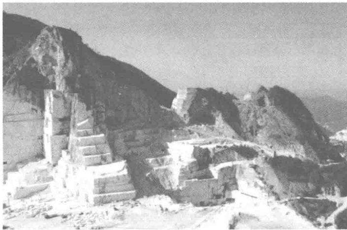
图 1-4 山坡露天开采大理石矿山
