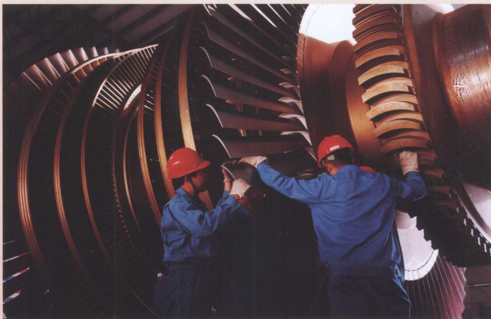
东方电气质检人员在制造厂检查汽轮机低压缸转子制造质量
