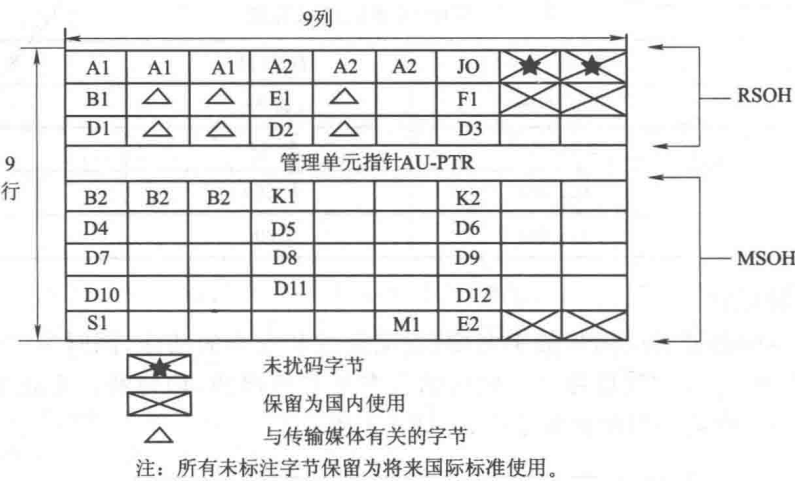
图 1-2 STM-1 SOH 段开销结构图
