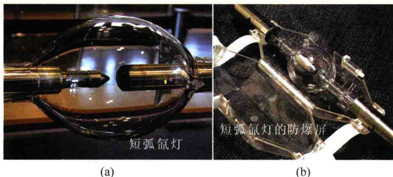
图 1.17 短弧氙灯 (a) 无防爆屏;(b) 带防爆屏。
