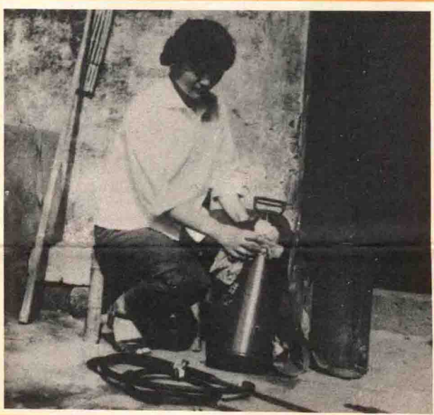
5. 使用完后，将喷雾器内外洗净、擦干。长期存放时，应将机具各金属螺纹、活动部位及没有防锈涂层的零件拆开，涂油防锈并装回，放在干燥通风处保存。
