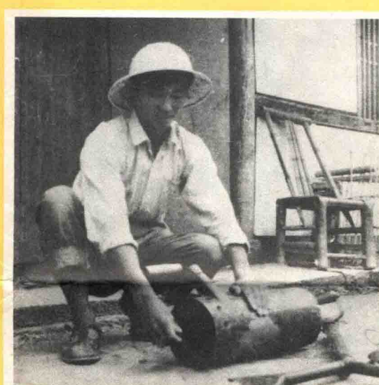
3. 加油时将盛满脂油的油杯盖旋入，直到脂油压入传动轴承内，并摇几转使其分布均匀。桶身两端的轴承孔内，应滴机油滑润。
