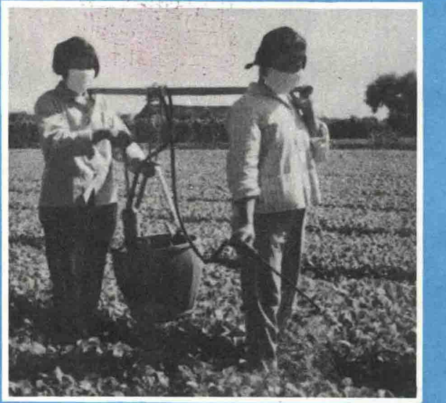
1. WD-0.55型单管喷雾器使用时须二人配合作业，前面的人拿喷杆，后面的人操作唧筒。
