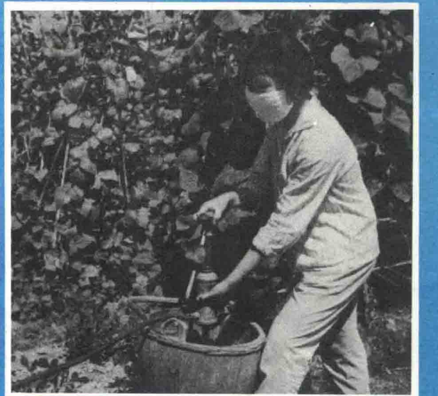
4. 操作唧筒的人抽压塞杆要均匀，使药液不断充入气室，才能保持一定压力的雾化状态。
