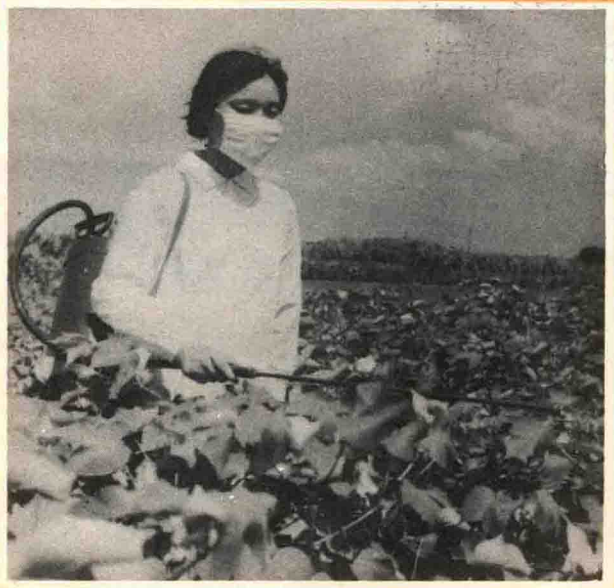
1. 552丙型压缩喷雾器是挂在肩上使用的。每次出工前先用清水试喷，检查各连接部位有否漏水、零件有否损坏，如有，要调整好才可使用。
