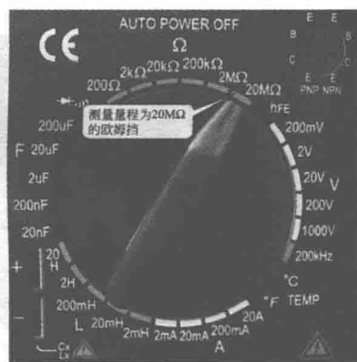
图 1-16 挡位选择开关及各种挡位
