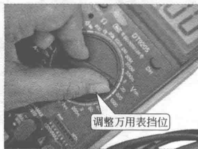
图 1-19 调整挡位选择开关至电压挡
