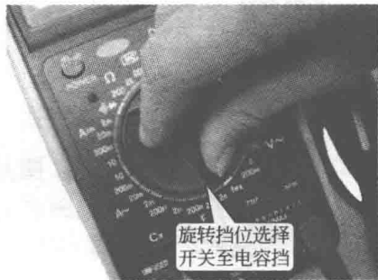
图 1-25 调整电容检测挡
