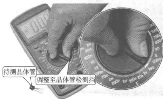
图 1-27 挡位选择开关调整至晶体管检测挡
