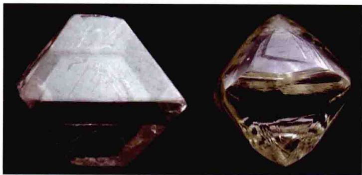
图1-2 钻石的八面体晶体
