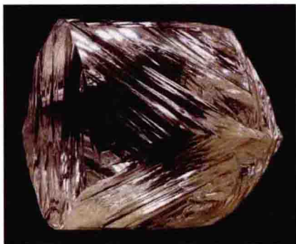
图1-8 钻石晶体表面的生长纹
