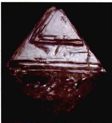
图1-12 钻石八面体晶面上的台阶状生长纹
