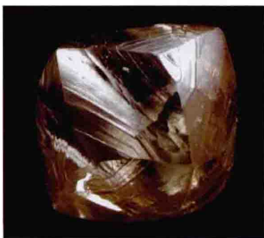
图1-10 钻石菱形十二面体晶体表面的生长脊
