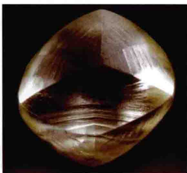
图1-10 钻石菱形十二面体晶体表面的生长脊
