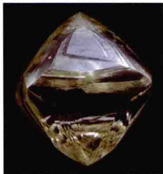
图1-9 钻石的八面体晶型及三角形生长锥
