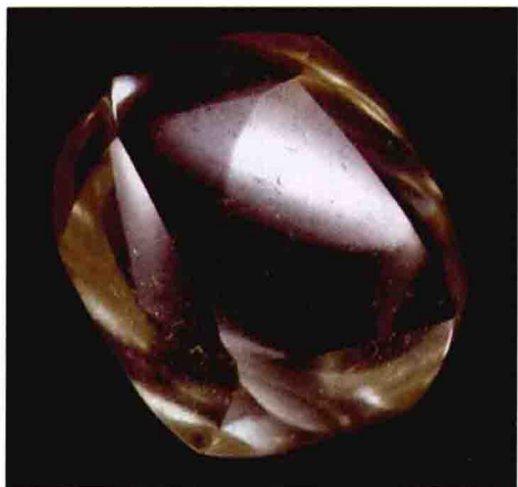
图1-3 钻石的菱形十二面体晶体
