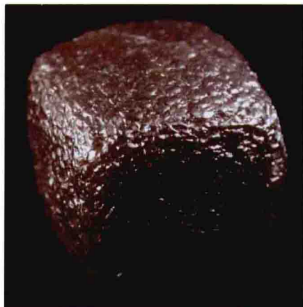
图1-4 钻石的立方体晶体
