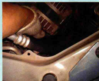
图 1-12 安装新发动机驱动带
