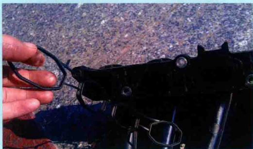
图 1-20 安装新进气歧管衬垫
