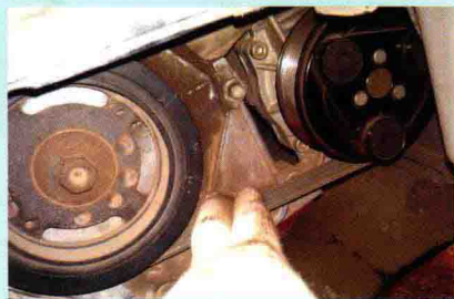
图 1-14 检查发动机驱动带预紧力
