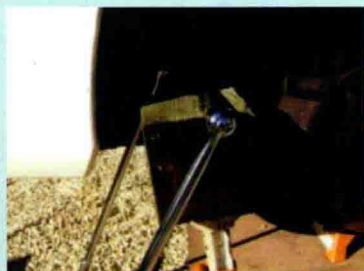
图 1-16 拆下曲轴带轮螺栓
