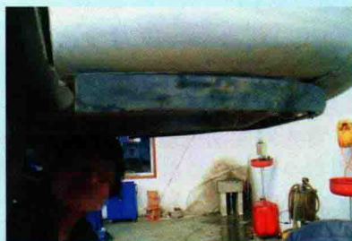
图 1-8 检查缸体漏油、漏水情况
