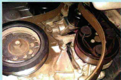
图 1-11 拆卸发动机驱动带
