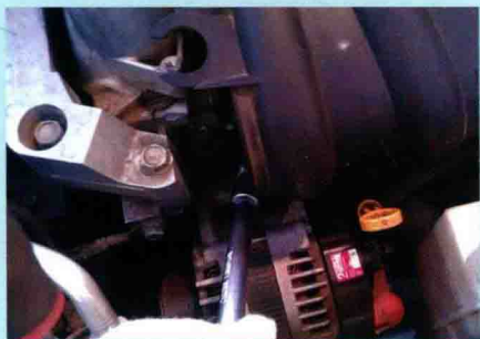
图 1-18 拆卸进气歧管紧固螺栓
