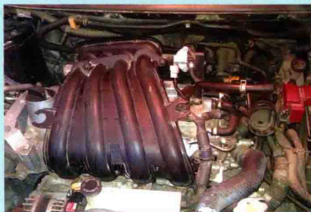
图 1-21 安装进气歧管相关部件
