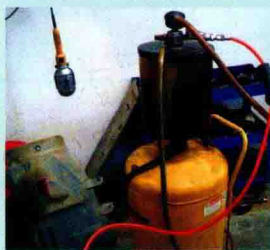
图 1-1 抽干发动机机油
