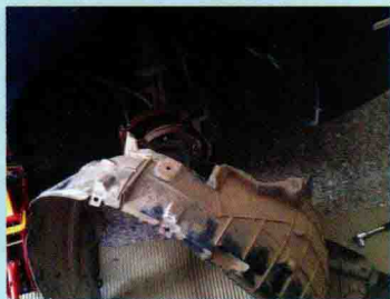
图 1-9 拆卸车轮及内衬板
