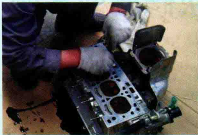
图 1-5 清洁气缸盖表面
