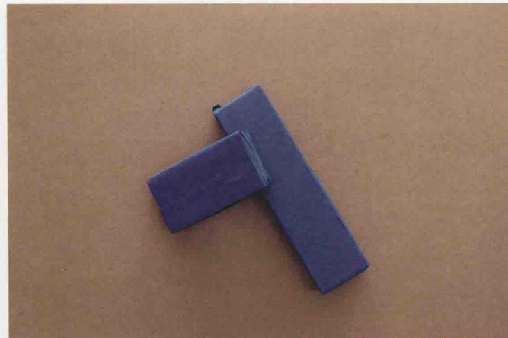
压铁石用于装订时固定书籍。压铁石不可太重也不可太轻，适当重量为宜。注意为防止铁锈破坏书叶将压铁用纸包裹。
