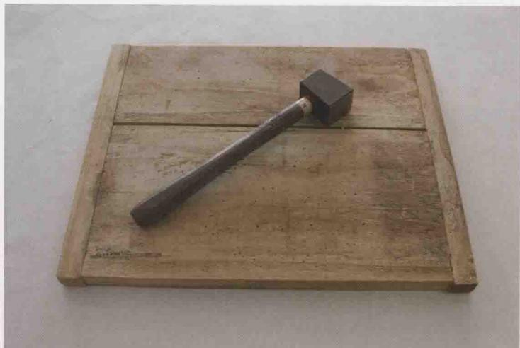
书锤用于敲平书叶。敲打破损古籍修补后叠加凸起的部位。
