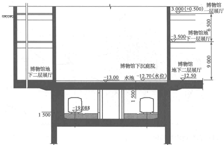
图 1-6 自然博物馆大基坑与 13 号线地铁基坑剖面位置关系图 (尺寸单位: mm; 高程单位: m)
