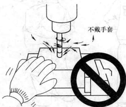
图1-7 钻床操作时不能戴手套
