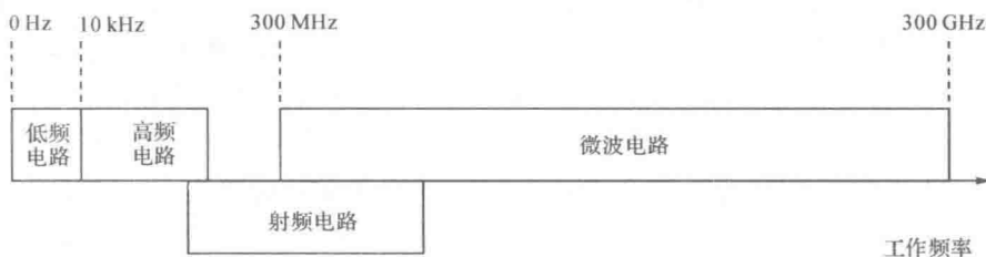
图 1-1 高频电路、射频电路和微波电路工作频率之间的关系
