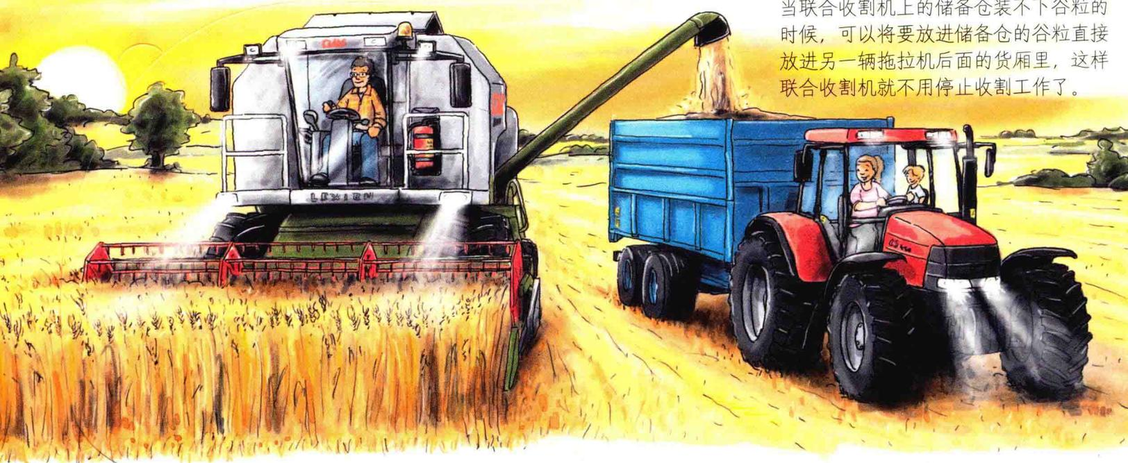
夏天，人们用联合收割机收割谷物、油菜和向日葵。这种大型机器可以在1小时之内收割大约15吨谷物——这差不多是一辆大型货车的装载量。联合收割机前面的刀片会将谷物的茎割断，然后将谷物送到
