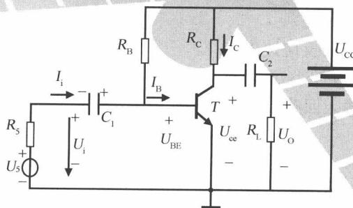
①该电路是交流放大电路;② $C_1$ 、 $C_2$ 元件是耦合电容,起隔直的作用;③ $R_B$ 电阻的主要作用是提供基极偏置电压及电流;④ $R_L$ 电阻表示负载;⑤该电路的直流通路和交流通路是一样的。
