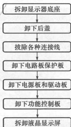
图 1-1-2 液晶显示器拆卸流程图
