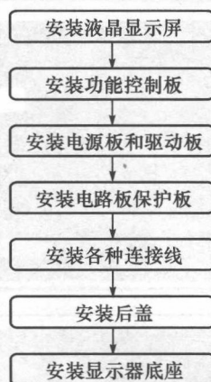
图 1-1-3 液晶显示器安装流程
