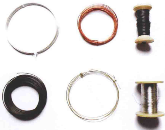
金属丝从左到右， 上面一行：银、铜、绑丝 下面一行：钢、黄铜、熔丝
