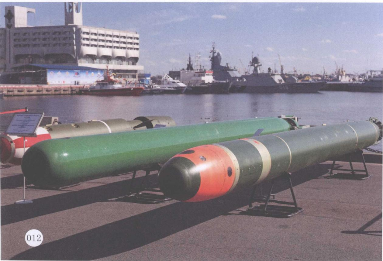
药在引爆时产生的威力，比导弹的要大。另外由于鱼雷采用水声音响制导，同时配以尾流制导修正，命中率很高，加上雷达波不能穿透海水，而鱼雷自身声响又很小，所以鱼雷非常不易被拦截。
