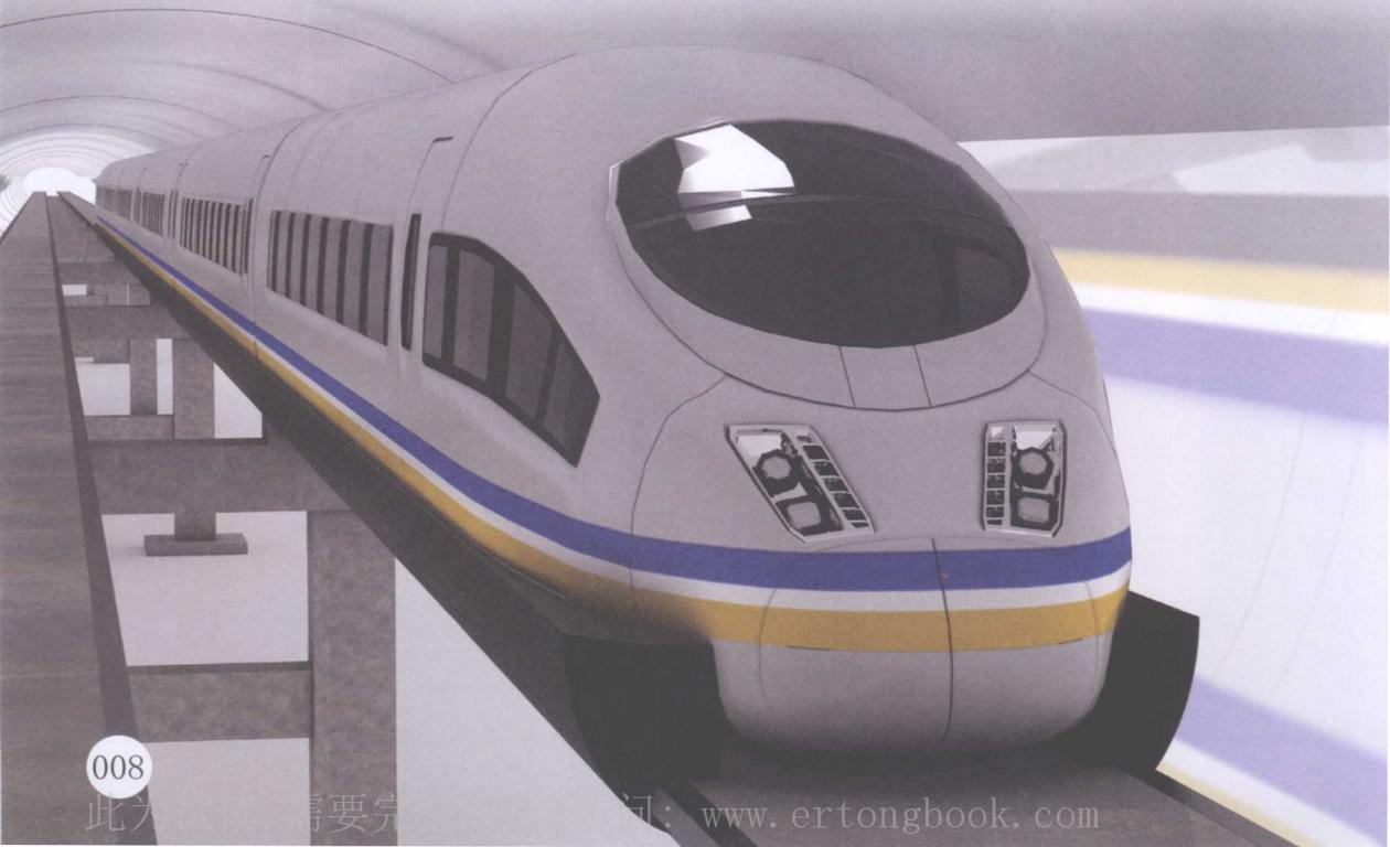
与列车重力平衡时，列车就可悬浮在轨道上方。另外，通过改变电流来控制超导体产生的磁场强度，还能改变列车悬浮的高度。
