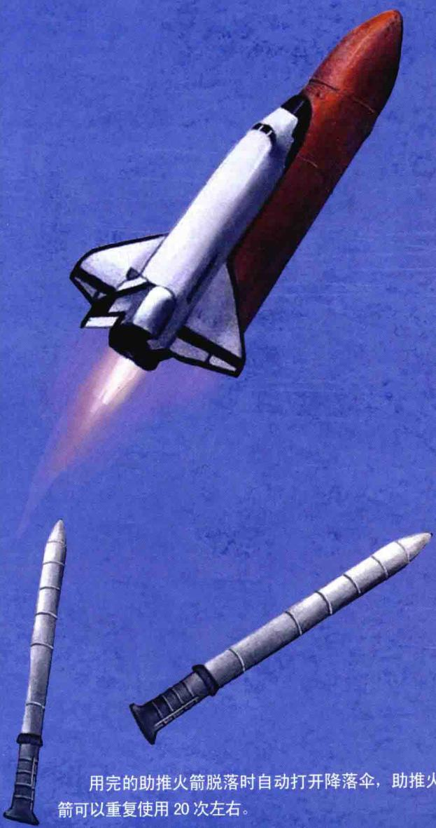
用完的助推火箭脱落时自动打开降落伞，助推火
